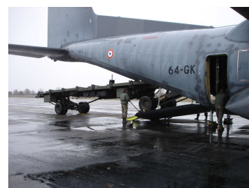
Chargement d'une plateforme élévatrice dans un TRANSALL C160.
